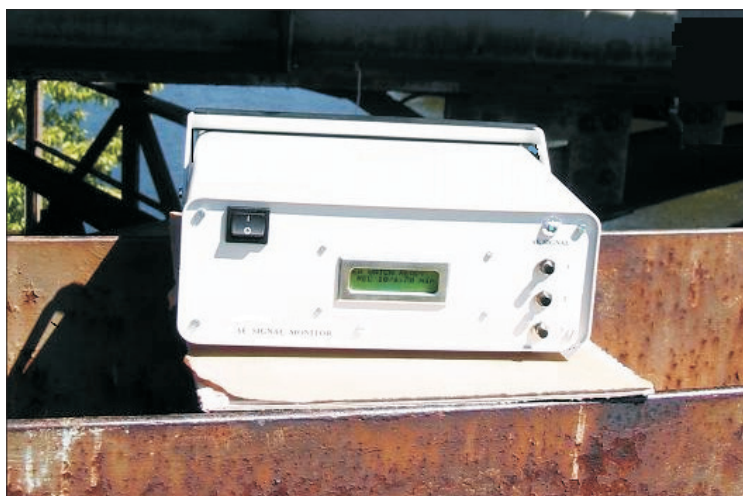
Rys. 4. Przenośny jednokanałowy analizator sygnału EA Fig. 4. A single-channel portable AE signal analyser
