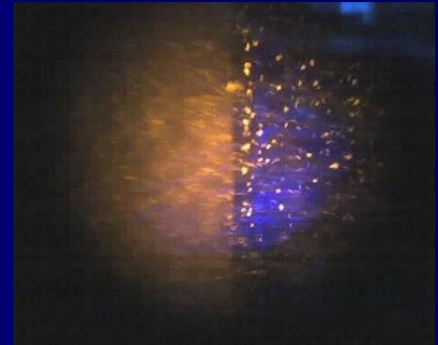
Fluorescencyjne cząstki znacznikowe ( 2\mu\text{m} ) widziane pod mikroskopem
