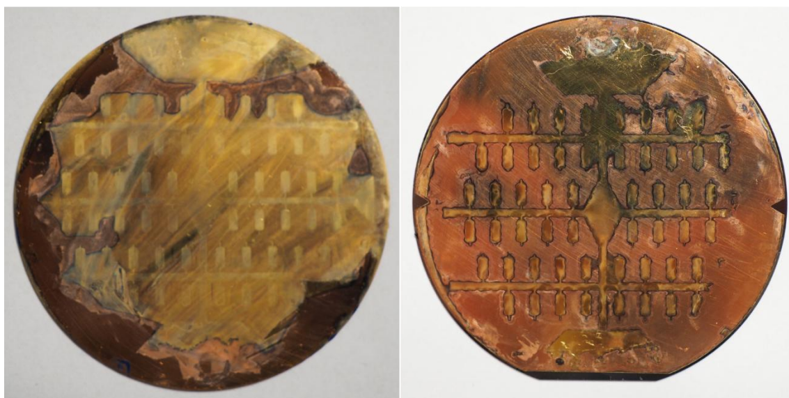
Rysunek 19. Zdjęcia podłoży z nieprawidłowo osadzonym złotem.
