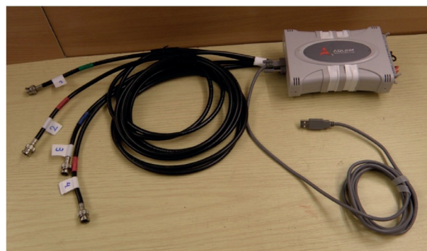
Rys. 3. Moduł do konwersji analogowo-cyfrowej i akwizycji danych typu USB-1901, firmy ADLINK INC
