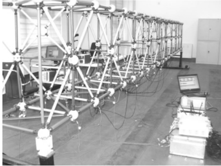
图2 整体加速度传感器布置图 Fig.2 Accelerations placement
