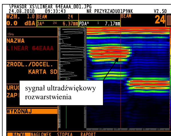
Rysunek 1. Wyniki pomiaru laminatu, zobrazowanie typu B – rozwarstwienie
