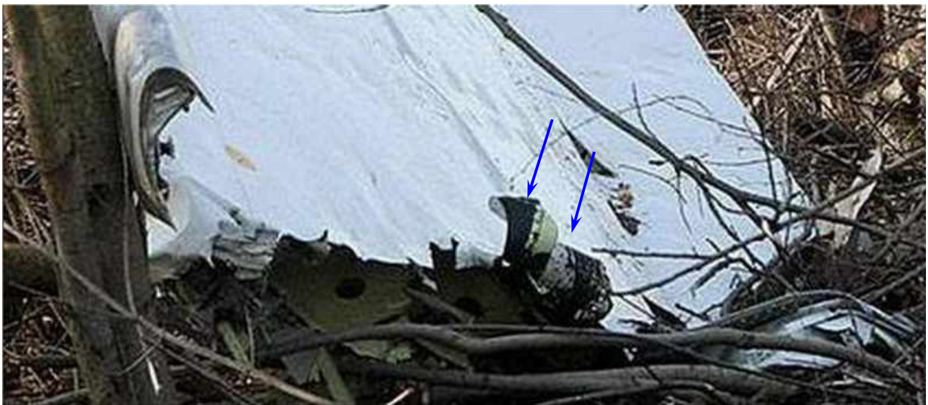
Rys. 18. Charakterystyczne płatki blachy na przelomie odcinka skrzydła, który odpadł od samolotu TU-154M, por. [5].
