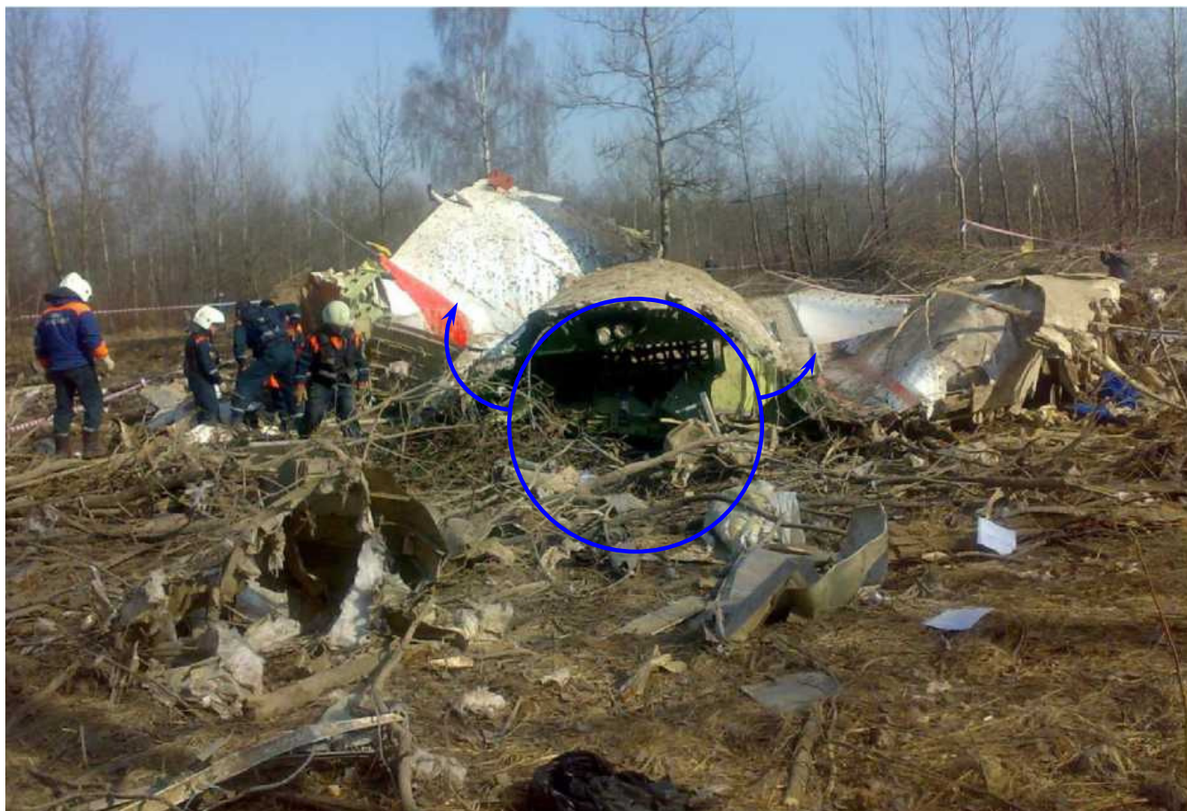
Rys. 16. Duży fragment kadłuba samolotu TU-154M, który spadł na ziemię rozerwany i z wywiniętymi na zewnątrz burtami, zdjęcie por. Raport Zespołu Parlamentarnego [5].
