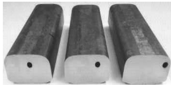
Rys. 6. Próbkki odniesienia do sprawdzenia wykrywalności wad typu 211.
