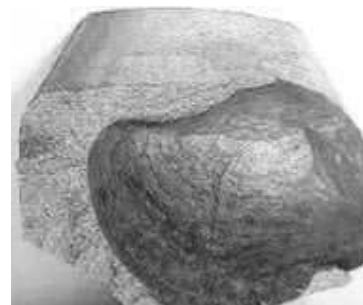
Rys. 11. Zobrazowanie wykruszenia krawędzi głowki (lewy obraz) oraz całkowitego pęknięcia poprzecznego (prawy obraz) zainicjowanego od wady typu Head Check.
