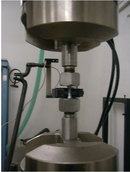
Rys. 12. Fotografia próbki, sposobu zamocowania i miejsca pomiaru zmiany średnicy
