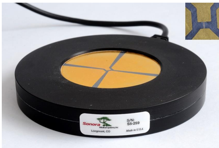
Rys.3. Hydrofon membranowy firmy Sonora, USA (obecnie Acertara Acoustic Labs, USA) [5]. W prawym górnym rogu pokazano powiększenie elementu aktywnego o średnicy 0.5 mm.
