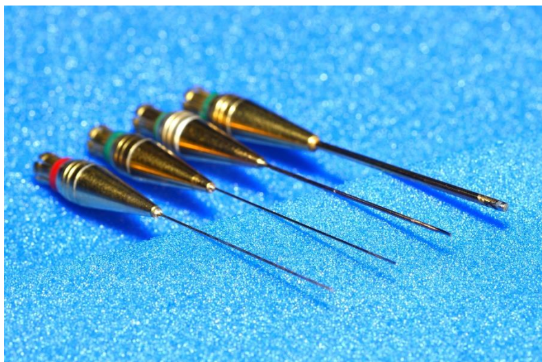
Rys.2. Zestaw czterech hydrofonów igłowych firmy Precision Acoustics, UK [4]. Średnica elementów aktywnych (folia PVDF) wynosi (od lewej) 40\ \mu\text{m} , 75\ \mu\text{m} , 0.2\ \text{mm} oraz 0.5\ \text{mm} .
