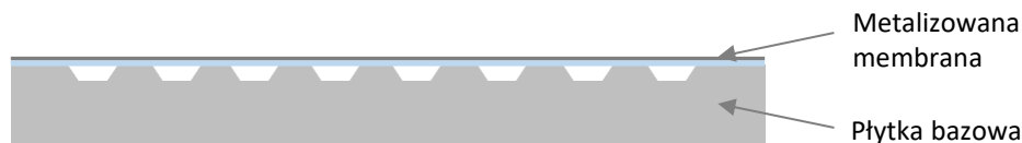
Rys. 6. Schemat budowy pojemnościowej głowicy ultradźwiękowej.
