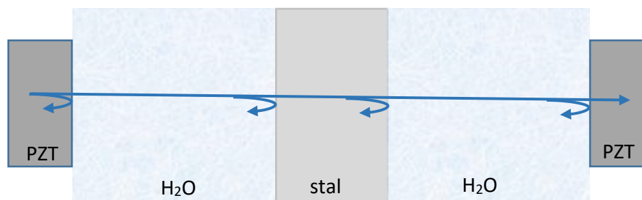
Rys. 1. Schemat badania zanurzeniowego metodą przepuszczania pokazujący straty amplitudy fali ultradźwiękowej przy przechodzeniu kolejnych granic ośrodków.
