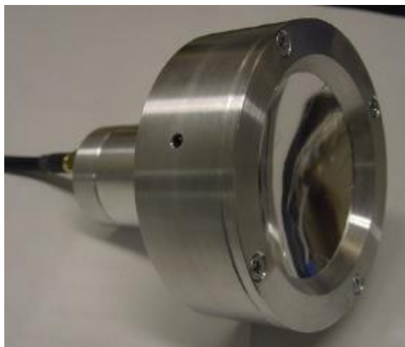
Rys. 8. Fotografija pojemnościowej głowicy skupiającej z powierzchnią aktywną ukształtowaną w postaci sfery.
