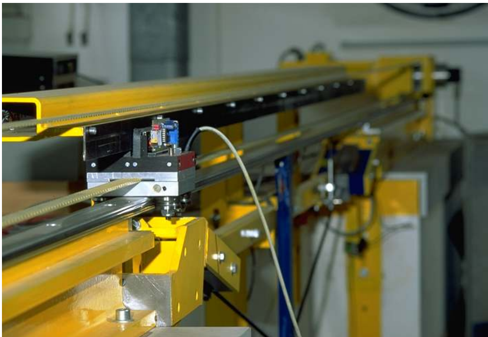
Rys. 5.4 Stanowisko laboratoryjne do badania aktywnej sterowanych drgań belki
