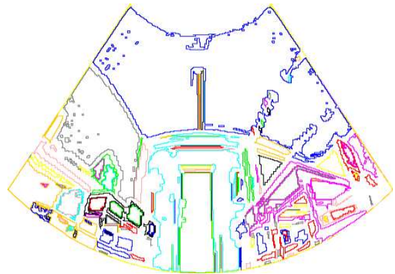
Rys. 1. Wykryte krawędzie obszarów przedstawionych na rys. 6 pracy [16] Fig. 1. Contours of polygons formed by edge-detection method applied for each area shown in Fig. 6 presented in [16]
