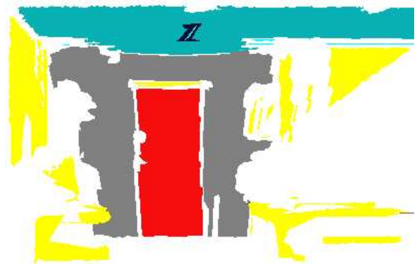
Rys. 2. Wynik klasyfikacji. Widoczne są drzwi (czerwone), ściana (szara), sufit (zielony) Fig. 2. 3D scene with areas labeled by the rule base classification system
