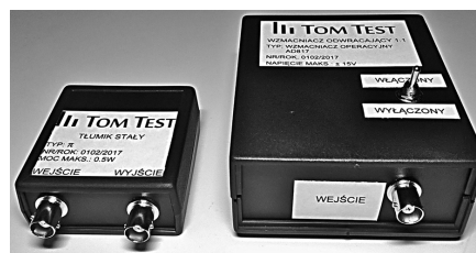
Rys. 2. Z lewej tłumik dopasowujący amplitudę impulsu nadawczego. Z prawej układ odwracający impulsy nadawcze defektoskopu ultradźwiękowego i dopasowujące go do standardu TTL Fig. 2. Silencer adjusting the amplitude of the transmit pulse (left). Inverted ultrasonic flaw detector and matched to TTL (right)
