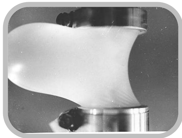
Badanie stateczności obracającej się membrany wypełnionej wodą. Wspólna praca z Donem Boyerem
